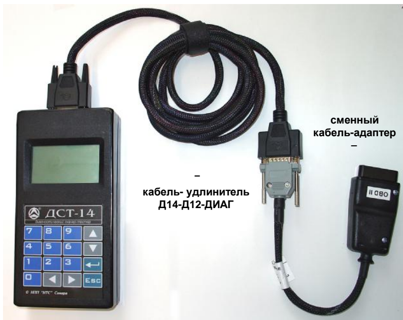
Рис. 2. Подключение кабелей к сканеру тестеру
